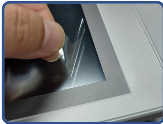
2) 撕除出厂PET保护膜，清洁原PET保护膜四周缝隙处的污染物
